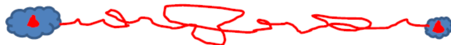
Flugbahn und Gewichtsverlust, bedingt durch Wasserverlust beim Lufttransport von Partikeln in Verbindung mit Aerosolen (feine Wasser-/ Flüssigkeitströpfchen).
