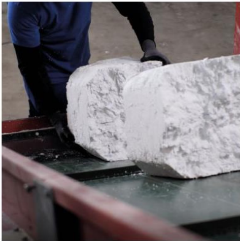
Erstellung von Styrodurbriketts aus Verschnitten und Verpackungsresten
